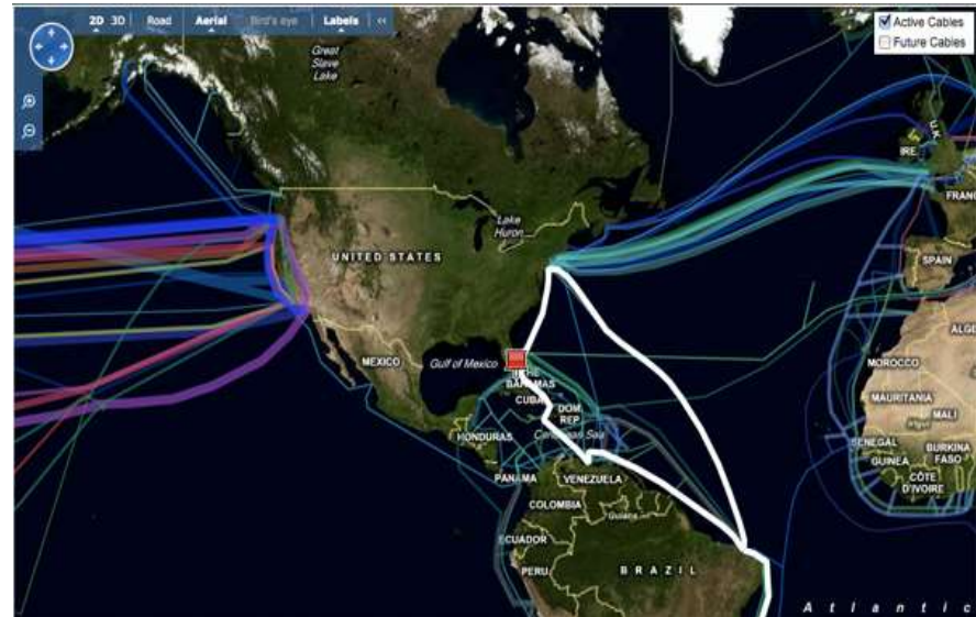
Conexiuni prin satelit ~ 1% Fibre optice pe fundul marii ~99% (2006)
